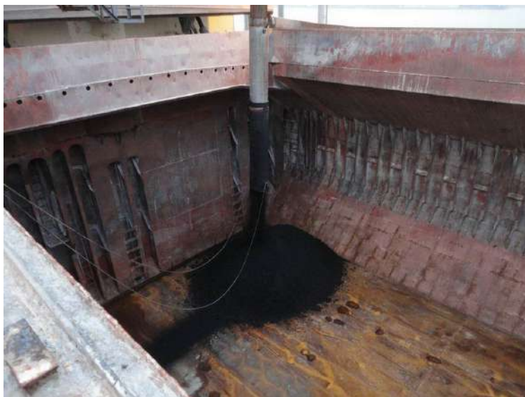
Рис. 1. Последствия горения деревянных брусьев в трюме
